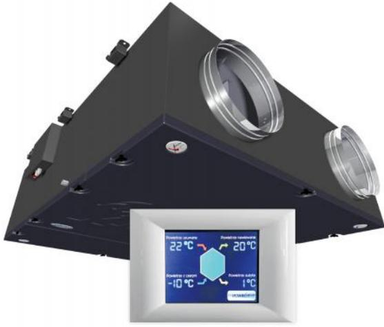
**Назначение:** подвесная установка Onyx Sky – является главным элементом приточно-вытяжной системы вентиляции с возвратом тепла. Она обеспечивает постоянный приток свежего воздуха в чистые помещения и вытяжку использованного воздуха, уменьшая при этом уровень CO<sub>2</sub> и влажности. Благодаря постоянной фильтрации предотвращает попадание аллергенов, а также развитие вирусов, бактерий, грибка.
