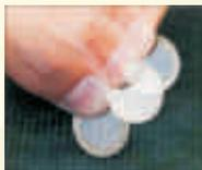
Прочность внутреннего покрытия плиты Climaver A2 Black подтверждает простой способ проверки, который заключается в приеме монеты.
