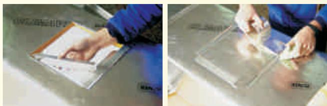
Наилучшие результаты чистки воздуховодов достигаются при использовании чистящих щеток. Чистка сжатым воздухом малоэффективна, особенно при загрязнениях, накопившихся на протяжении долгого периода.
